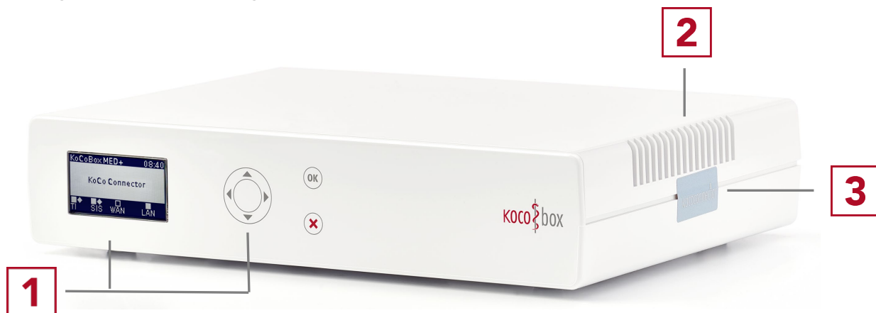
Abbildung 12: KoCoBox MED+ (G3) - Seitenansicht rechts mit Sicherheitssiegel
