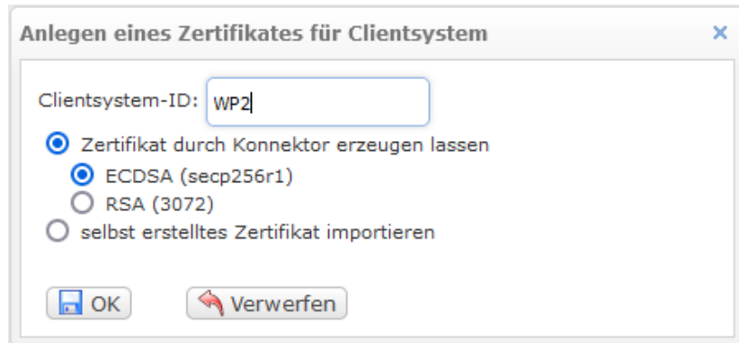
Abbildung 73: Konfiguration zum Anlegen eines Clientsystem-Zertifikats mit ECC
