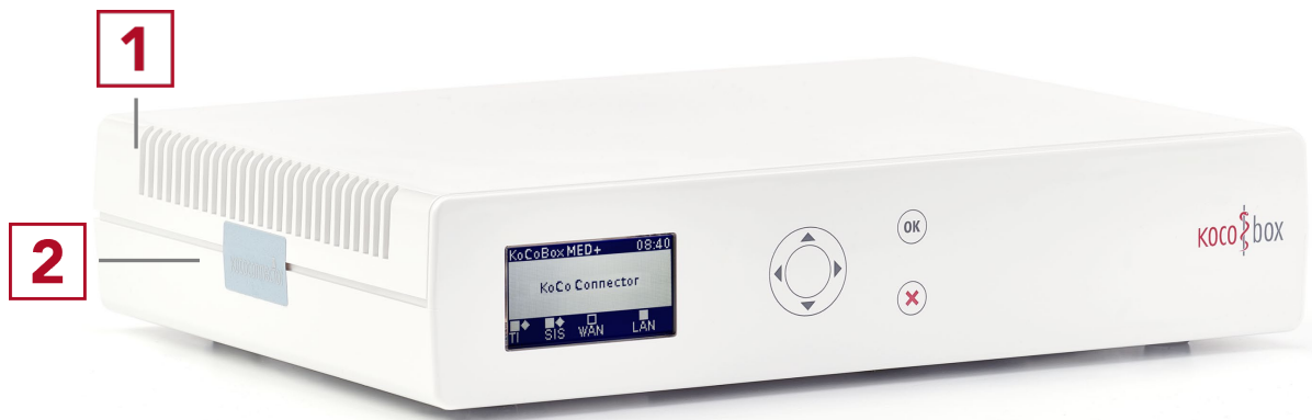
Abbildung 13: KoCoBox MED+ G3 - Seitenansicht links mit Sicherheitssiegel
