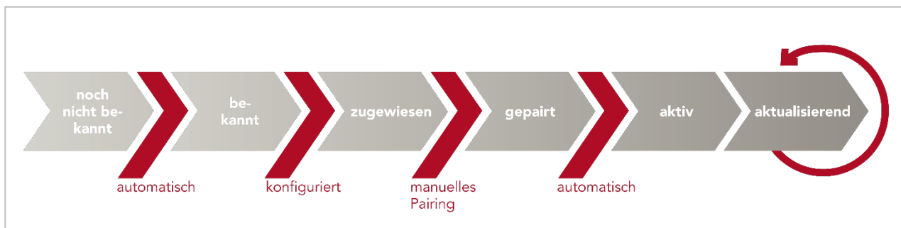
Abbildung 83: Übersicht der Verbindungsstatus eines Kartenterminals zum Konnektor
