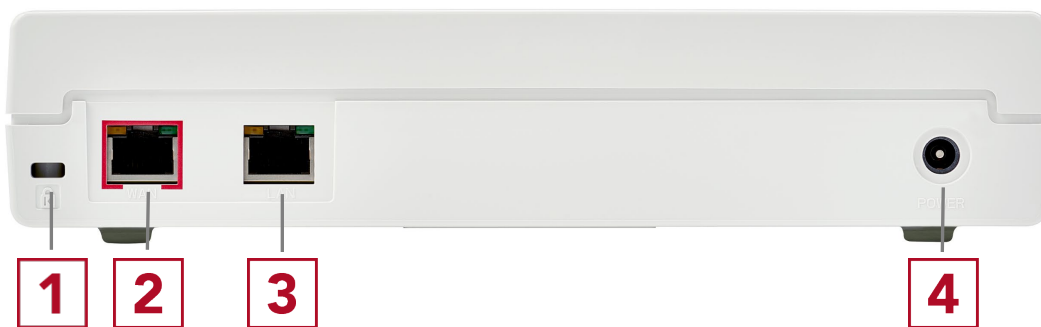
Abbildung 18: Rückseite der KoCoBox MED+ (G3) mit Anschlüssen
